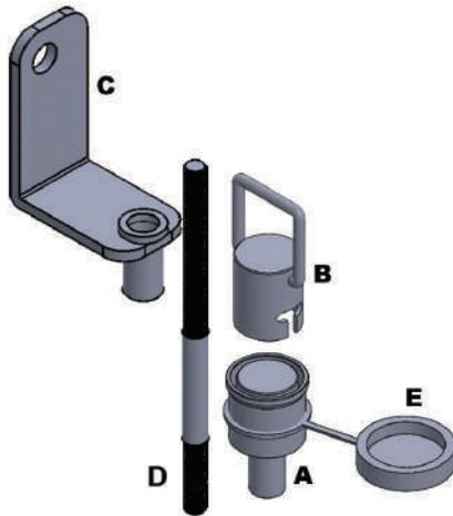
3º Suba o estepe centralizando o prisioneiro do suporte (D) dentro de um dos furos da roda conforme figura abaixo.
