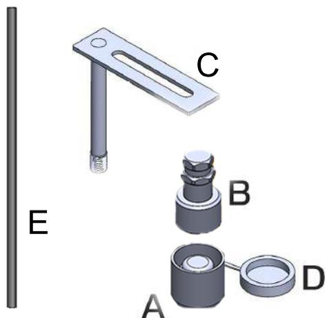
3° Rosqueie o pino guia (E) para facilitar a centralização do parafuso do suporte (C) dentro de um dos furos da roda. conforme figura abaixo, e depois retire o pino guia.
