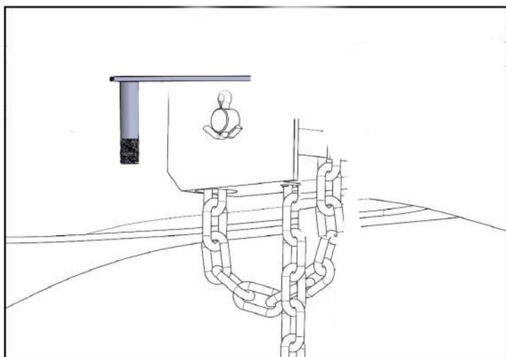
2° passo: Retire apenas um parafuso original do redutor e parafuse nosso suporte (C), conforme figura acima, Após a instalação.
